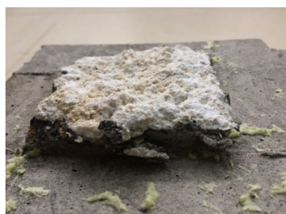
图6 砾屑结构礁灰岩-C30 混凝土 CNL 剪切破坏面
