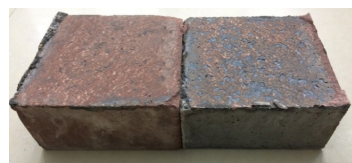
图8 红砂岩-C30 混凝土 CNL 剪切破坏面
